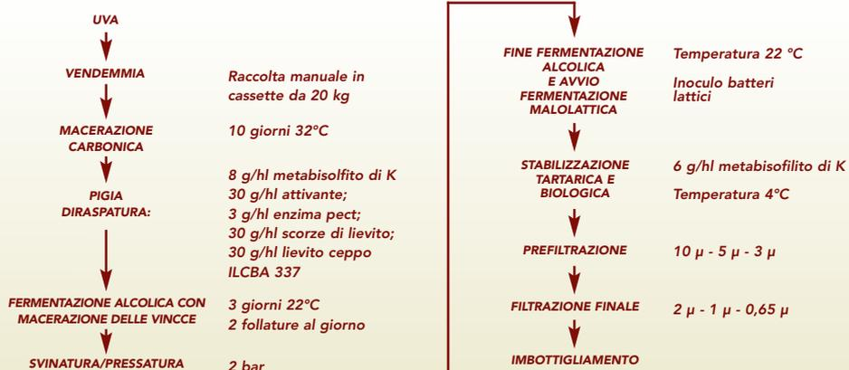
**Fig.4** DIAGRAMMA DI FLUSSO VINIFICAZIONE TRADIZIONALE "IN ROSSO"
